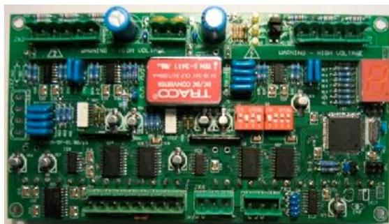
La scheda elettronica SNI-API è un'unità di acquisizione dati da segnali synchro, loro elaborazione e trasmissione su linea seriale.
